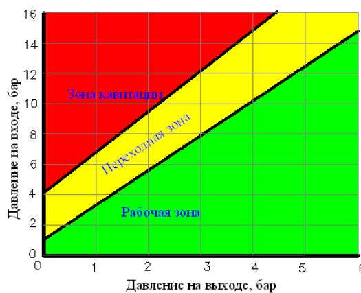
4.3. **Границное условие 2:** соотношение давления на входе и на выходе должно быть таким, чтобы попадать в рабочую или переходную зону графика кавитации.
